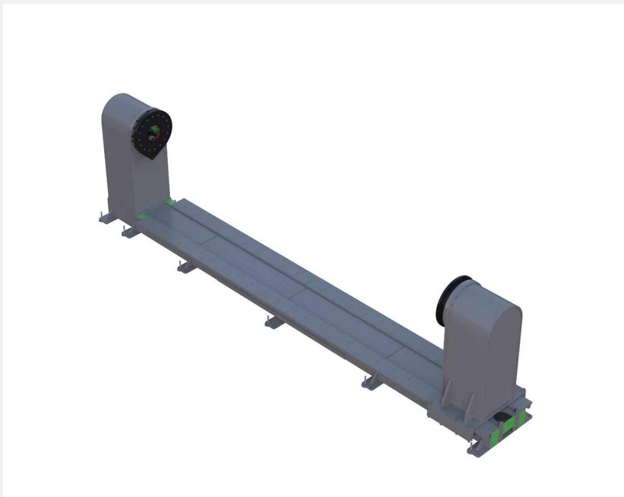
Tornio in linea. E' il più classico dei posizionatori di saldatura. Disponibile con differenti portate, lunghezze e diametri rotabili. La contropunta può essere fissa o mobile o scorrevole su guide. Questo posizionatore di saldatura è per pezzi lunghi che necessitano di essere ruotati tramite un asse controllato e sincronizzato dal robot.
