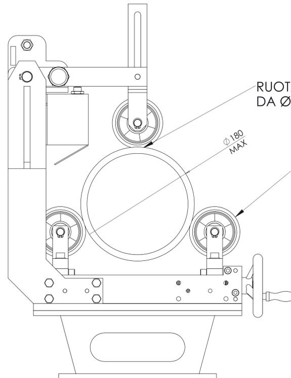
RUOTA SUPERIORE PER BLOCCAGGIO
