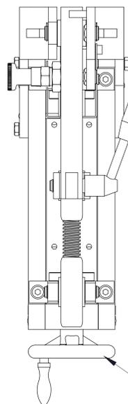
MANIGLIA "A RIPRESA" PER BLOCCAGGIO RUOTA SUPERIORE
